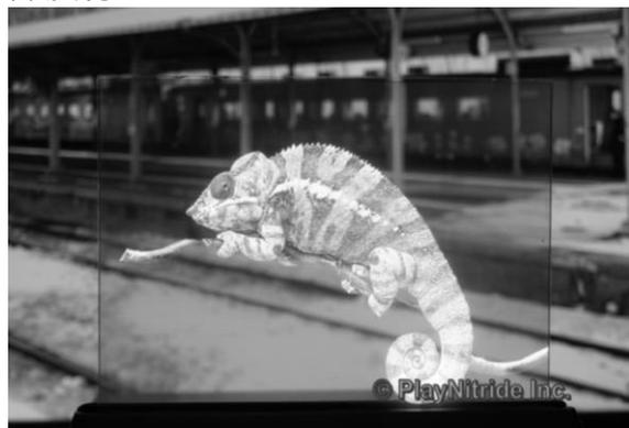
图 5 PlayNitride 与天马合作, LTPS TFT 驱动 7.5-inch  $720 \times 480$  分辨率,透过率  $> 60\%$ ,边框  $< 0.7\text{mm}$
